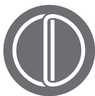
TxおよびRxコイル巻き線が重なり合う部分で最も強い信号が発生します。
